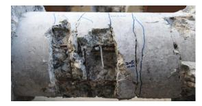
(d) Tensile side of core concrete
